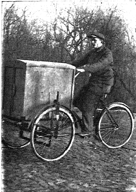
Rys. 7. Cyklonetka do rozwżenia wodomierzy.
