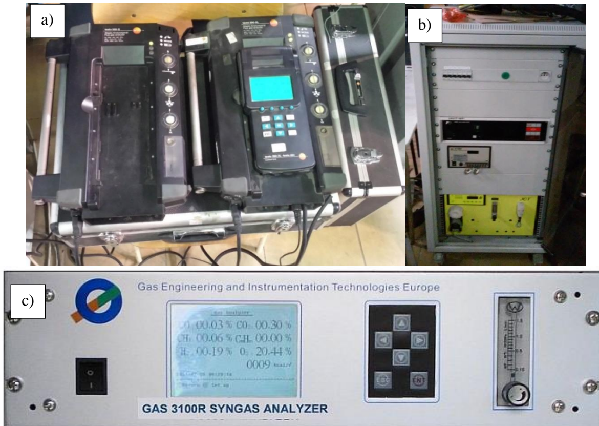
Rys. 3. Analizatory wykorzystane w trakcie badań, a) - TESTO 350 XL i TESTO 350 S, b) - Fuji typ ZRE, c) - GAS 3100 R
