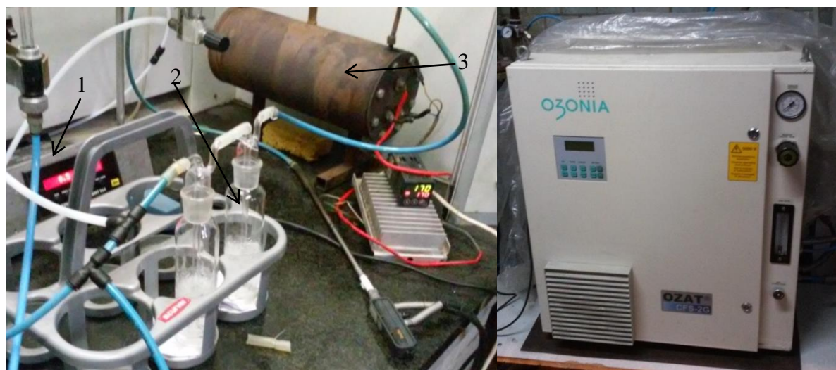
Rys.5.2. Fragment instalacji badawczej oraz generator ozonu, 1- analizator stężenia ozonu, 2- płuczki z roztworem NaOH (absorber), 3- destruktor ozonu
