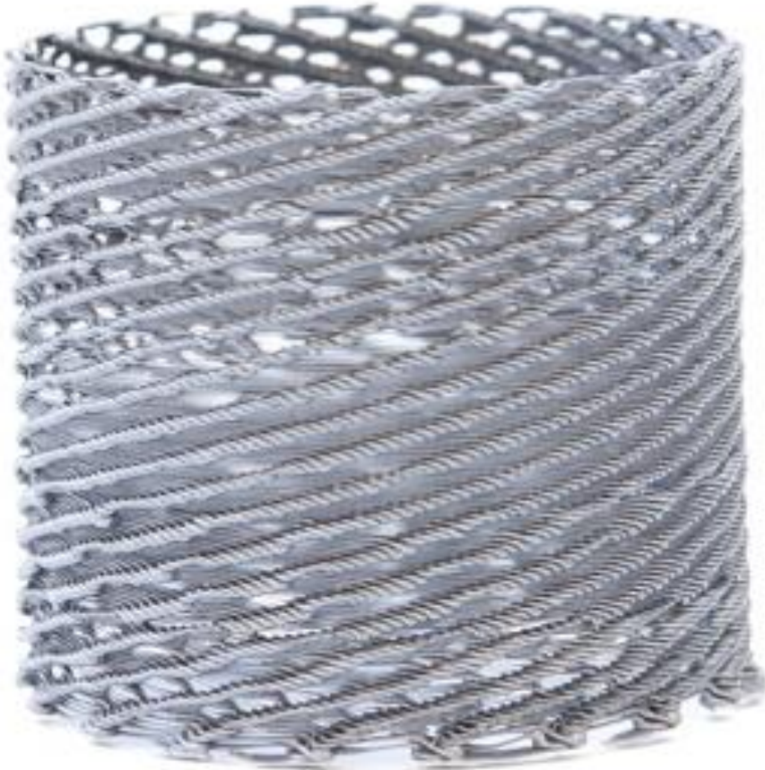
Fig. 14. 18 ribs with 240°, V_{rib} : 400 mm/min, V_{cyl} : 1600 mm/min
