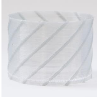
Fig. 2. 12 ribs with 90°, V_{rib} : 400 mm/min, V_{cyl} : 800 mm/min
