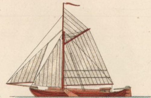
ANDERHALFMAST BEZAANTUIG. BESANTAKELUNG MIT 1 1/2 MAST. GRÉEMENT D'ARTIMON A 1 1/2 MAT.
