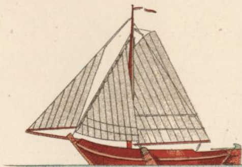
BEZAANTUIG. BESANTAKELUNG. BESAN RIG. GRÉEMENT D'ARTIMON.
