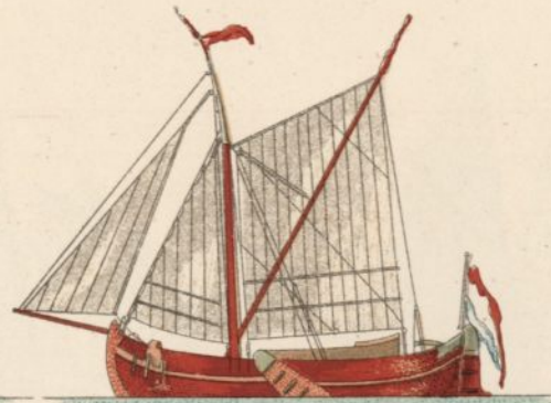
SPRIETTUIG (OUD MODEL). SPRIETTAKELUNG (ALTE ART). SPRIT RIG (OLD FORM). GRÉEMENT A LIVARDE (TYPE ANCIEN).
