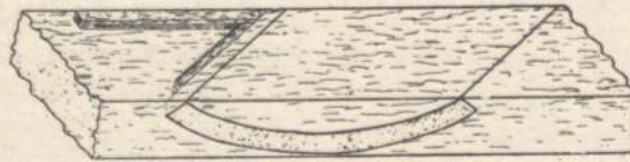
Abb. 540. Das auf das Kropfholz angerissene Kropfstück.
