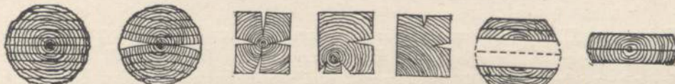
Abb. 907. Abb. 908. Abb. 909. Abb. 910. Abb. 911. Abb. 912. Abb. 913. Das Schwinden, Quellen, Reißen und Werfen des Holzes.
