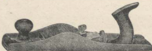
Abb. 949. Hirnholz hobel mit sehr flach liegendem 51 mm breitem Eisen und verstellbarem Hobelmaul. Hobellänge 35 cm. Beim Treppenbau zum Bestoßen der Wangenstöße sehr geeignet.
