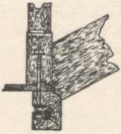
Abb. 48. Umständliche und nicht zu empfehlende Befestigung der Antrittspfosten.
