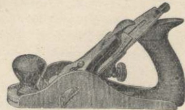
Abb. 942. Putzhobel, dessen Eisen so breit ist wie die Hobelsohle (zugleich als Sims- und Falzhobel verwendbar).
