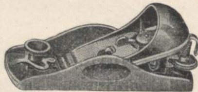
Abb. 948. Glatter Hirnholz hobel 15—18 cm lang (Eisenbreite 44 mm).
