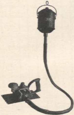
Abb. 1073. Der durch die biegsame Welle angetriebene Handkraft-hobel 1 (gerade Einstellung).
