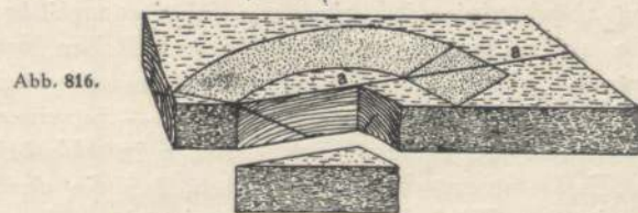
Abb. 815 und 816. Empfehlenswerte Anreißkonstruktion zum Vormachen der Krümmungsschablone.
