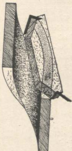
Abb. 844. Das Auflegen des Krümmingsholzes auf das Kropfstück zur Ermittlung des Senkels bzw. der Verkantung.
