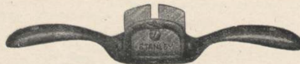
Abb. 953. Schabhobel mit gebogenem Griff. Hobellänge 25 cm, Eisenbreite 50—54 mm.
