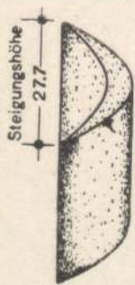
Abb. 291. Das Übergangskropfstück zu Abb. 285 seitlich gesehen.
