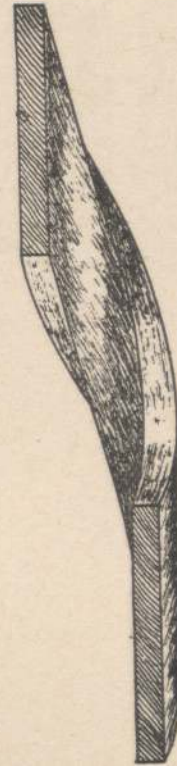
Abb. 501. Das fertige Kropfstück zu der dreiviertelsgewundenen Treppe in Abb. 500.
