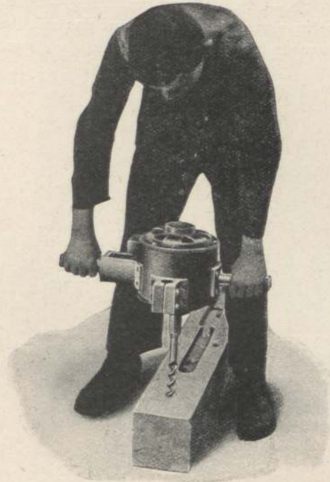
Abb. 1042. Der Motor der „Treppa“ abgenommen, dient als elektrische Handbohrmaschine.
