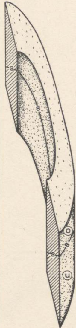
Abb. 567. Das zu schmale Kropfstück ist etwa in der Mitte abgeschwungen (s. den Schwungriß s). Der Schwungriß ist auf beiden Seiten und rechtwinklig zum Kropfsenkel mit einer geraden Papierschablone anzureißen (abzuschwingen).
