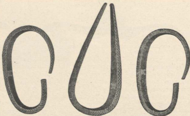
Abb. 966. Schwanhäse (rauere und feinere Arten), für Geländermacher sehr geeignet.
