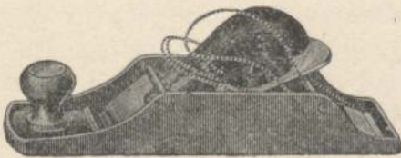
Abb. 940. Verstell- und umschlagbarer Schlichthobel (20 cm lang, Eisenbreite 44 mm).
