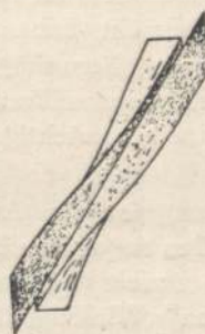
Abb. 840. Der nach der Senkelverkantung hergestellte Krümmling ist nach dem Verschnneiden übereinander geschoben, damit er etwas stärker wird.
