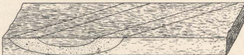
Abb. 603. Das nach der hohen Steigungshöhe gerissene Übergangskropfstück.
