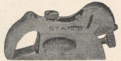
Abb. 945. Verstellbarer Simshobel (etwa 10 cm lang, Eisenbreite 25 mm).
