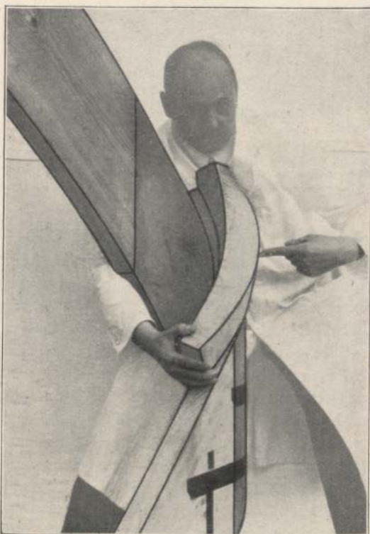
Abb. 869. Der in Abb. 868 (nach der Papierschablone von Abb. 866) ausgetragene und seitlich winkelverkantete untere Krümmling sackt in seiner Mitte (s. den Hinweis des Geländermachers mit dem Zeigefinger).
