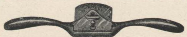
Abb. 954. Schabhobel mit gebogenem Griff und verstellbarem Hobelmaul. Hobellänge 25 cm, Eisenbreite 50—54 mm.
