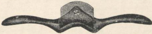
Abb. 958. Schabhobel mit hohler Schneide und doppeltem Eisen. Hobellänge 25 cm, Eisenbreite 50–54 mm.
