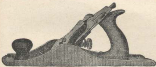
Abb. 937. Eiserner (amerikanische Raubbank in verschiedenen Größen (45–60 cm lang).
