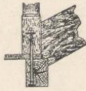
Abb. 48. Umständliche und nicht zu empfehlende Befestigung der Antrittspfosten.
