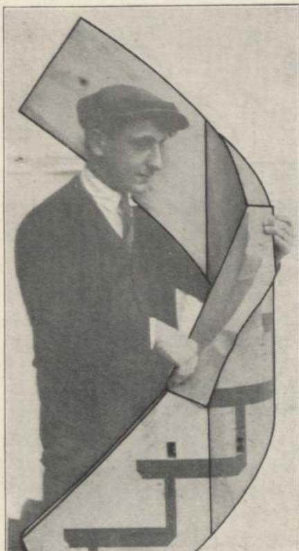
Abb. 866. Das Abnehmen der Papierschablone zu dem unteren Krümmung. Der Geländermacher drückt ein Stück Papier auf die Kropfoberkante fest auf und reißt die Kropfform mittels eines langen jedoch stets senkrecht geführten Bleistiftes auf die untere Papiersseite an.
