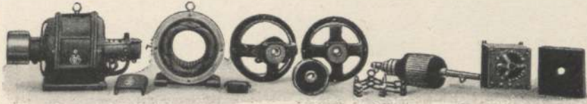
Abb. 978. Drehstrom-Schleifringankermotor ohne Bürstenabheber und seine Einzelteile mit luftgekühltem Anlasser.
