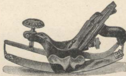
Abb. 938. Der einfache verstellbare Schiff- und Rundhobel (ca. 26 cm lang, Eisenbreite 44–46 mm).
