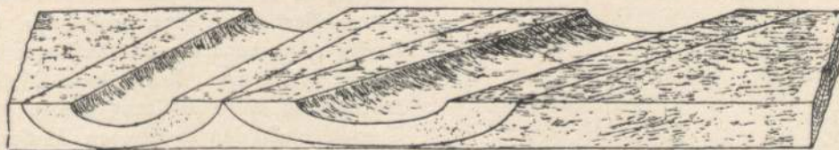
Abb. 601. Das auf das Kropfholz nach der kleinen und großen Verstreckungsschablone angerissene und halbausgeschaffte Übergangskropfstück.
