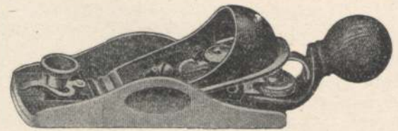
Abb. 947. Hirnholz hobel mit Griff (Hobellänge 15—18 cm, Eisenbreite 44 mm).
