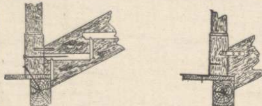
Abb. 56. Vielfach übliche aber nicht empfehlenswerte Befestigungen der Antrittspfosten.
