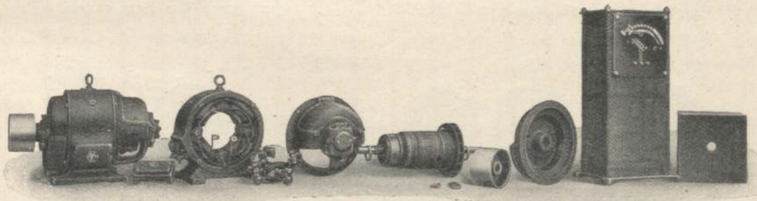
Abb. 974. Der halbgeschlossene Gleichstrom-Nebenschluß-Motor und seine Einzelteile (mit luftgekühltem Ankerfeld-Regulier-Anlasser).
