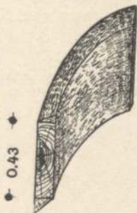
Abb. 258. Das fertige ausgearbeitete aber noch nicht abgekantete Viertelkropfstück zu der Treppe in Abb. 239.
