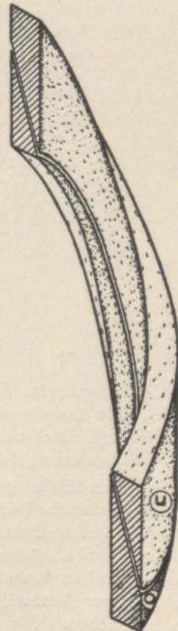
Abb. 564. Die beiden Schwungabfälle u und o umgekehrt aufeinander geleimt, geben ein schmales Kropfstück.
