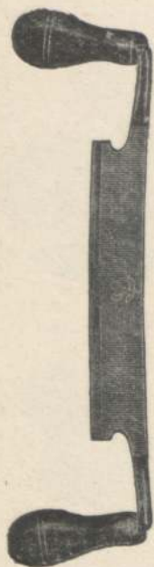
Abb. 961. Das gerade Schneid- oder Zugmesser.
