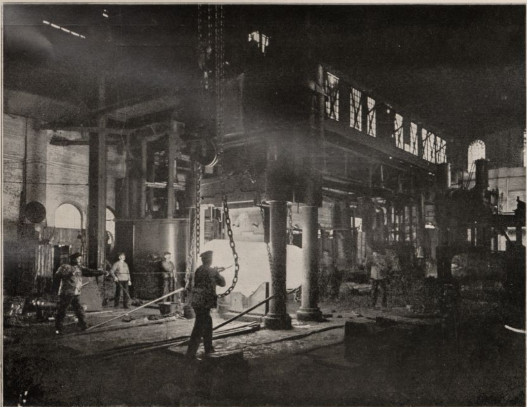
Abb. 8. Schmiedepresse von 2000 t Druck in Gleiwitz
