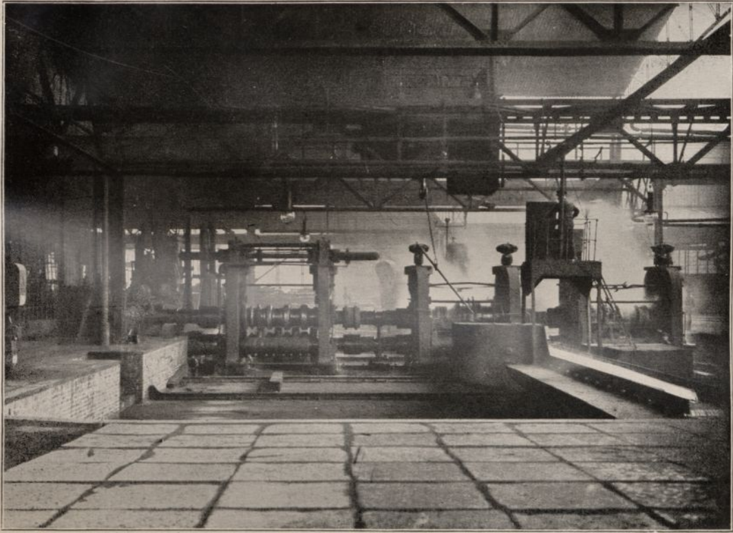
Abb. 7. Elektrisch angetriebene Grobstrecke in Friedenshütte
