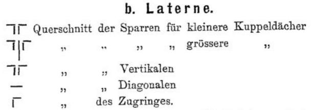
Die erforderlichen Anschlussnieten zu den für die Kuppeltheile verwendeten Winkeleisen sind der Tabelle Seite 130 zu entnehmen. Zur Ermittlung der Anschlussnieten, welche für die verwendeten Flacheisen angenommen und erforderlich sind, dient die folgende Tabelle. Die Scheerfestigkeit des Nieteisen ist auch hier zu  $\frac{4}{5}$  der Zugfestigkeit des Flacheisens angenommen.
