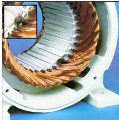
Rys. 3.2. Zniszczone miejsca wyprowadzenia uzwojenia ze żłobka [152]
