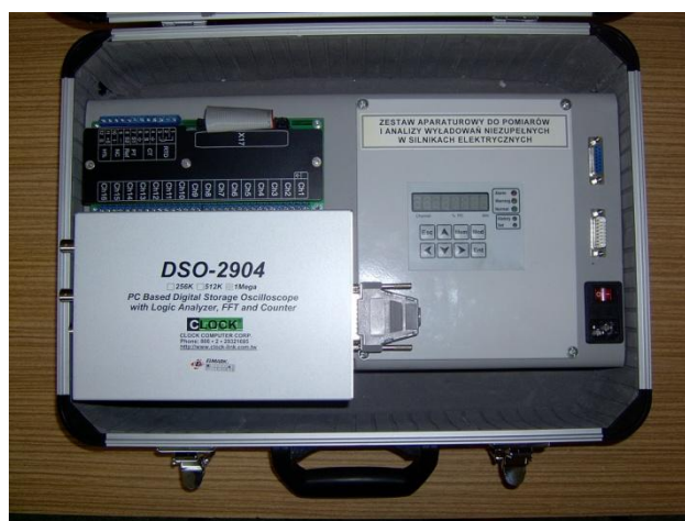
Rys. 5.1.9. Przenośny zestaw aparaturowy do pomiarów wnz silników [126]
