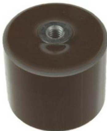
Rys. 6.1.1. Kondensator ceramiczny wielowarstwowy 2nF 40 kV \pm 10\% Z5T dielektryk montaż śrubowy TDK (wg RS-Electronic)
