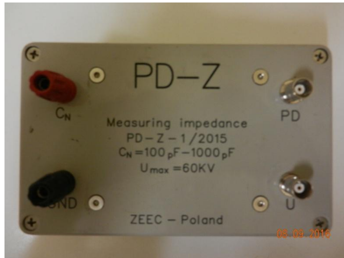
Rys. 7.1.2. Moduł wykonanej przez autora impedancji pomiarowej
