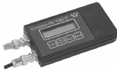
Rys. 9.5. a) Kalibrator wnz GKI-2 zestawu R500, b) Impuls generowany przez kalibrator
