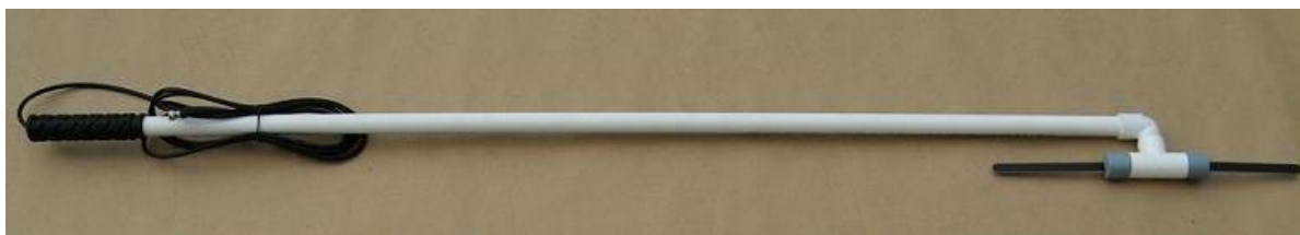
Rys. 4.2.23. Antena przenośna do pomiarów wnz
