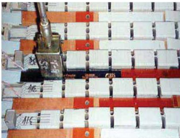
Rys. 4.2.15 b. Rozmieszczenie anten paskowych w żłobkach [123,125,127]
