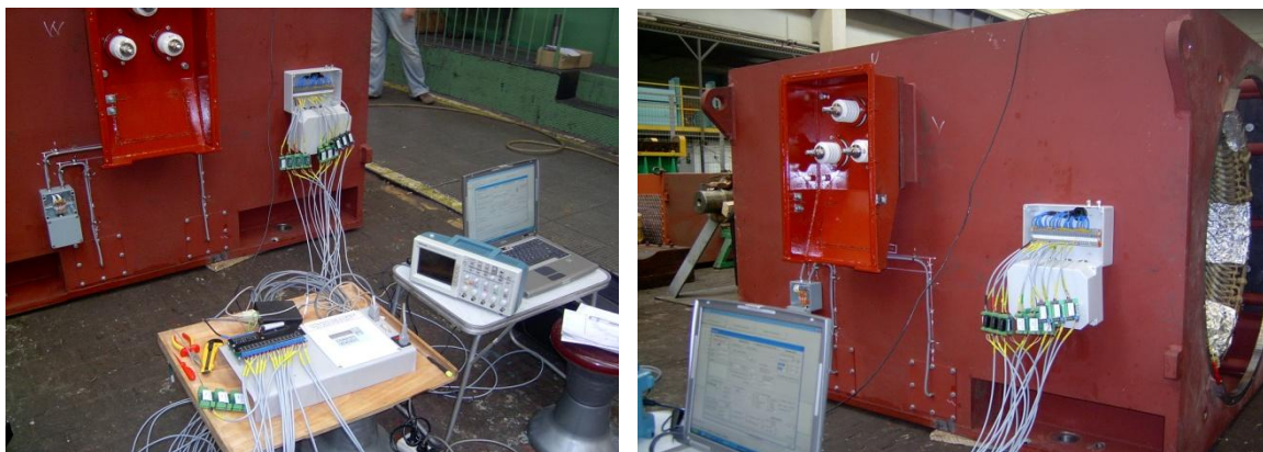
Rys. 8.1. Przykład kalibracji torów pomiarowych w nowo zbudowanym silniku o mocy 1,4 MW [126]
