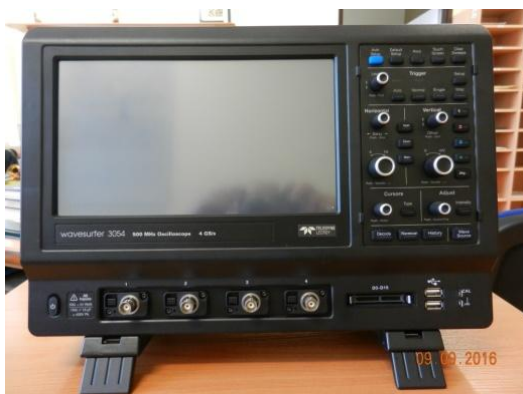
Rys. 4.3.1.. Fotografie oscyloskopów używanych przez autora do obserwacji wyładowań wnz
