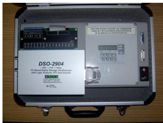
Rys. 4.3.1.. Fotografie oscyloskopów używanych przez autora do obserwacji wyładowań wnz
