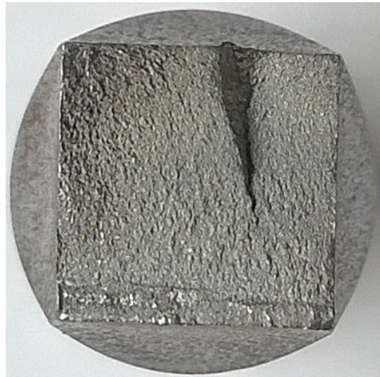
Rys. 66. Przelomy zmęczeniowe stali C45 uzyskane przy zginaniu z kontrolowaną amplitudą a) momentu zginającego, b) parametru energetycznego próbek o przekroju poprzecznym kwadratowym
