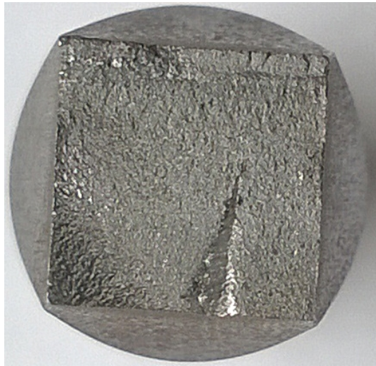
Rys. 66. Przelomy zmęczeniowe stali C45 uzyskane przy zginaniu z kontrolowaną amplitudą a) momentu zginającego, b) parametru energetycznego próbek o przekroju poprzecznym kwadratowym
