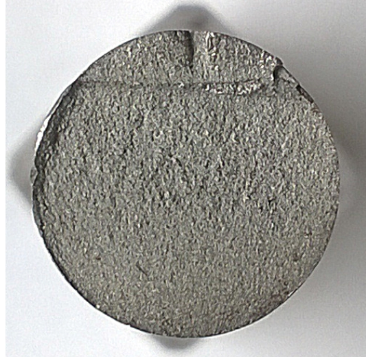
Rys. 65. Przelomy zmęczeniowe stali C45 uzyskane przy zginaniu z kontrolowaną amplitudą a) momentu zginającego, b) parametru energetycznego próbek o przekroju poprzecznym okrągłym
