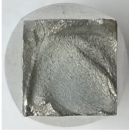
Rys. 68. Przelomy zmęczeniowe stopu aluminium 2024 uzyskane przy zginaniu z kontrolowaną amplitudą a) momentu zginającego, b) parametru energetycznego próbek o przekroju poprzecznym kwadratowym
