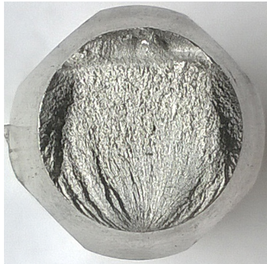
Rys. 67. Przełomy zmęczeniowe stopu aluminium 2024 uzyskane przy zginaniu z kontrolowaną amplitudą a) momentu zginającego, b) parametru energetycznego próbek o przekroju poprzecznym okrągłym
