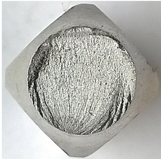
Rys. 67. Przełomy zmęczeniowe stopu aluminium 2024 uzyskane przy zginaniu z kontrolowaną amplitudą a) momentu zginającego, b) parametru energetycznego próbek o przekroju poprzecznym okrągłym
