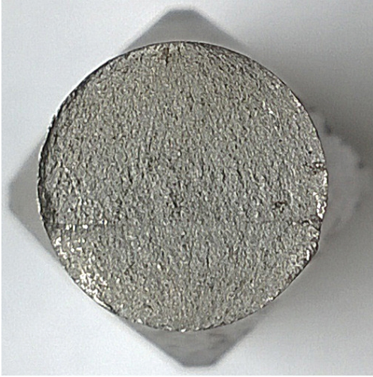
Rys. 65. Przelomy zmęczeniowe stali C45 uzyskane przy zginaniu z kontrolowaną amplitudą a) momentu zginającego, b) parametru energetycznego próbek o przekroju poprzecznym okrągłym
