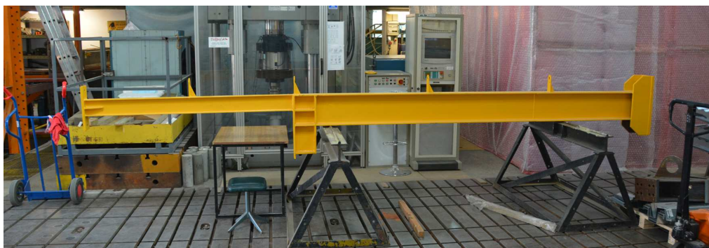
Rys. 3.2. Badany dwuteowy słup stalowy
