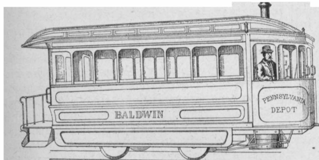
Rys. 6. Wagon parowy wytwórni parowozów Baldwin w Filadelfji z r. 1875
