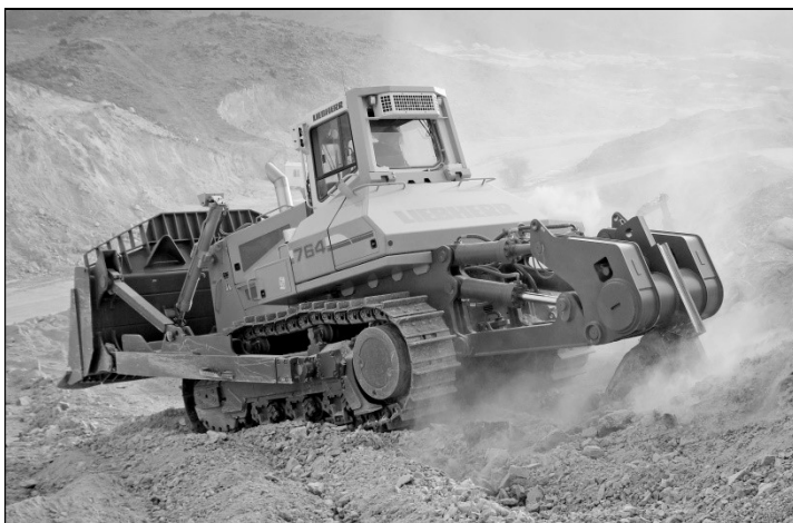
Rys. 4. Spycharka PR764 z pojedynczym zrywakiem (Liebherr-Polska)
