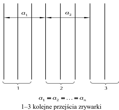
Rys. 5. Schemat zrywania równoległego w skałach łatworabialnych (Hawrylak i in. 1975)
