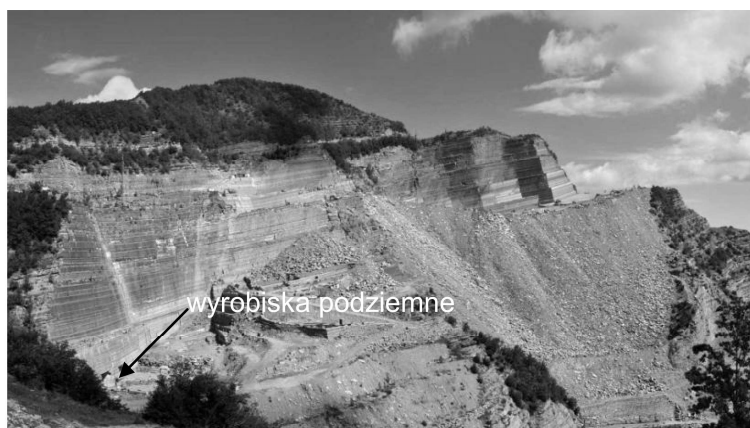
Rys. 5. Kopalnia piaskowca Brento Alto – wyrobisko odkrywkowe oraz korytarze udostępniające część podziemną – po lewej stronie u dołu ( www.calamini.it )
