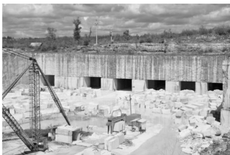
Rys. 8. Kopalnia wapieni Kanfanar – korytarze udostępniające część podziemną oraz wyrobiska podziemne ( www.kamen-pazin.hr )
