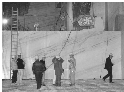
Rys. 3. Eksploatacja tzw. marmurów „użyłonych” z czarnymi smugami związanymi z obecnością domieszek grafitu w kopalni Acqua Bianca ( www.eacd.cc ) Fig. 3. Extraction of so-called „vein” marble with black streaks related to presence of graphite in Acqua Bianca mine ( www.eacd.cc )
