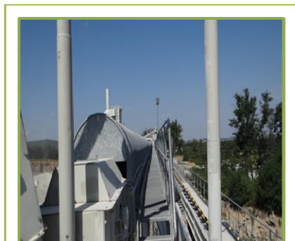
Rys. 8. Obudowy i osłony przenośnikowe w kopalni Wieśnica (fot. M. Stefanicka) Fig. 8. Rehandling cases and guards at the conveyor at Wieśnica Mine (photo M. Stefanicka)
