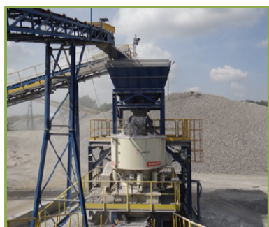
Rys. 2. Widok węzła III stopnia kruszenia w kopalni Łażany - praca pod pełnym obciążeniem i zraszaniem nadawy (fot. M. Stefanicka)
