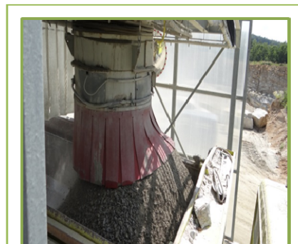
Rys. 9. Załadunek kruszywa 0/32 rękawem teleskopowym - odpylana i zraszana stacja załadunkowa w kopalni Wieśnica (fot. M. Stefanicka) Fig. 9. Aggregate 0/32 loading with telescopic sleeves - system at Wieśnica Mine (photo M. Stefanicka)
