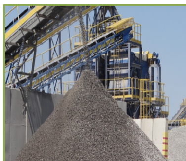
Rys. 3. Widok magazynu produkcyjnego w kopalni Łażany - zraszany stożek 16/22 (fot. M. Stefanicka)
