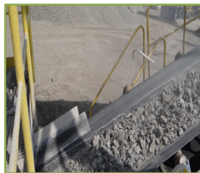
Rys. 5. Widok wysypu z kruszarki II stopnia przerobu w kopalni Łażany - zraszanie włączone (fot. M. Stefanicka)
