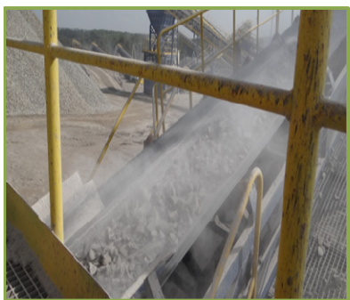
Rys. 4. Widok wysypu z kruszarki II stopnia przerobu w kopalni Łażany - zraszanie wyłączone na czas pomiarów (fot. M. Stefanicka)
