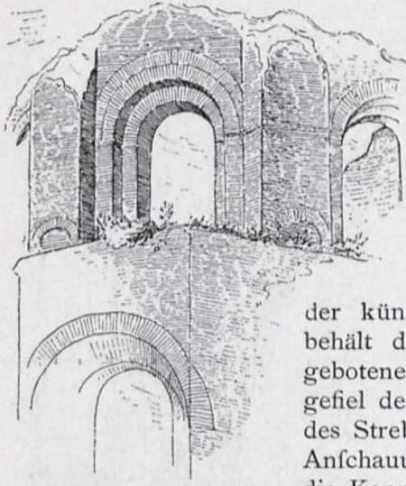
Fig. 395. Strebepfeiler am Tempel der sogenannten Minerva Medica. Nach Durm.
