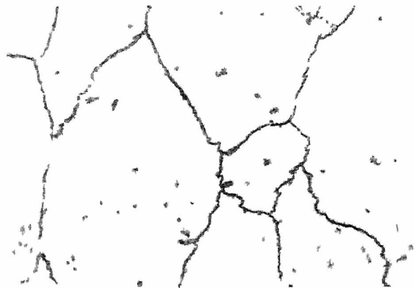
Rys 3 Traw odcz. Fry'a Pow. 500 X Mikrostruktura spoiny wykonanej elektrycznie elektrodą ze stali austenitycznej ognioodpornej
