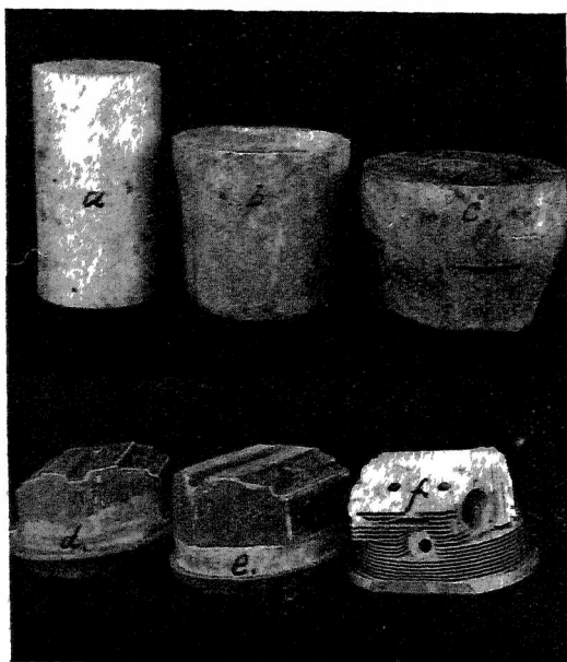
Rys. 4. Głowica cylindrowa. a — bloczek odlany, b — spęczony, c — po pierwszym ubiciu, d — po 2-m ubiciu, e — głowica po stoczeniu szwu, f — głowica gotowa (obrobiona).
