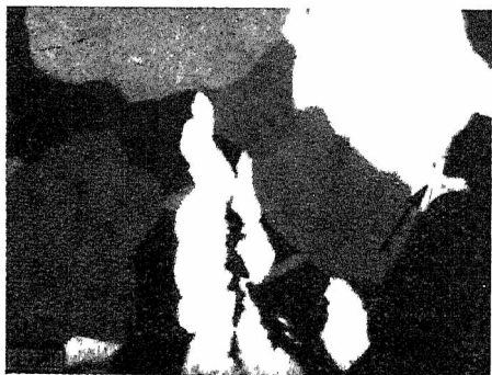
Rys. 8. Zarodek kryształu wskazany na rys. 7 rozwinął się w pełny kryształ. Strzałka obok wskazuje nowy zarodek.
