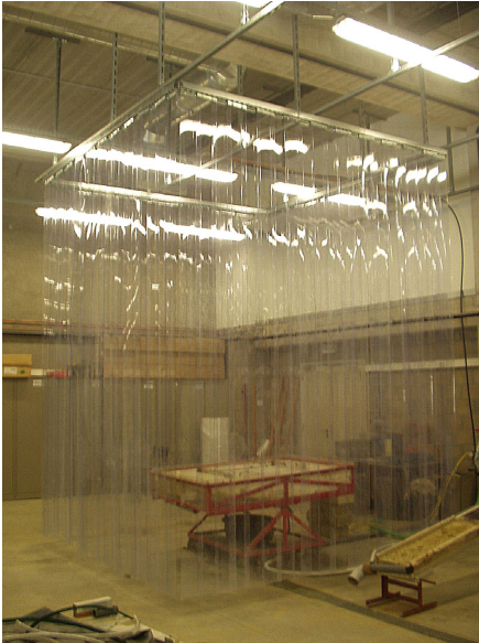
Fot. 4.7. Pomiary rozbryzgu w warunkach symulowanego opadu w Laboratory for Experimental Geomorphology na Katholieke Universiteit w Leuven, Belgia (fot. autor)
