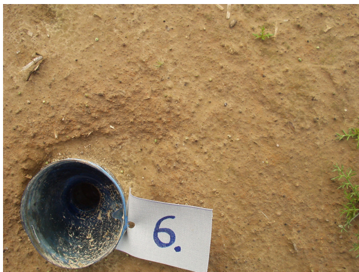
Fot. 4.5. Pomiary rozbryzgu metodą „splash cup” (fot. autor) Phot. 4.5. Splash cup measurement in study field (phot. author)
