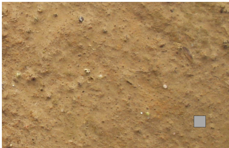
Fot. 7.2. Uszczelnienie powierzchni gleby lessowej powstałe na skutek zjawiska rozbryzgu – Boleścín, październik 2003 r. (długość boku kwadratu w prawym dolnym rogu: 5 mm, fot. autor)
