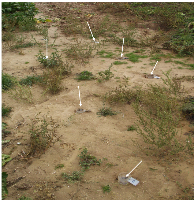
Fot. 4.4. Pomiary rozbryzgu wykonywane techniką „splash cup” (fot. autor) Phot. 4.4. Splash cups measurements in study field (phot. author)
