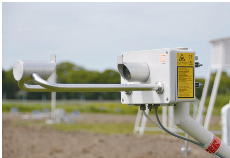
Fot. 4.1. Disdrometr laserowy zamontowany na terenie Obserwatorium Agro- i Hydrometeorologicznego Uniwersytetu Przyrodniczego we Wrocławiu (fot. autor)
