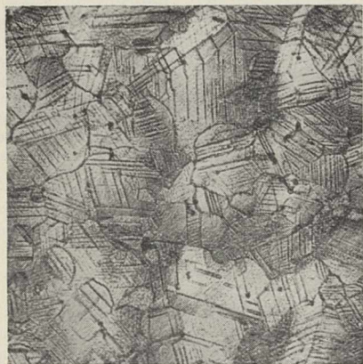
FIG. 5. Microstructure at axe edge. \times 100 .
