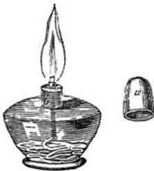
aber, in welcher der Verbrennungsprocess statt findet, weißglühend wird. Da der Alkohol leicht verfliegt, so löscht man die Flamme aus, indem man die Kappe *a*, welche luftdicht auf die Lampe aufgeschliffen ist, darauf stellt.
