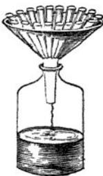
Um größere Mengen Phosphor auf diese Weise zu oxydiren, steckt man jede einzelne Stange Phosphor in ein Glasrohr, welches unten eine enge Oeffnung hat, und legt die Glasröhren in einen Trichter, welcher in die Oeffnung einer Flasche gestellt wird. Um den Staub abzuhalten, bedeckt
