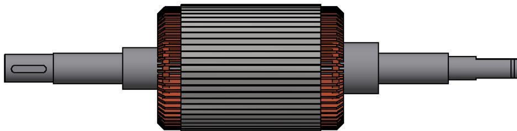
Rys. 1. Model wirnika trójfazowego silnika klatkowego dużej mocy Fig. 1. The model of three phase motor with squirrel cage rotor high-power
