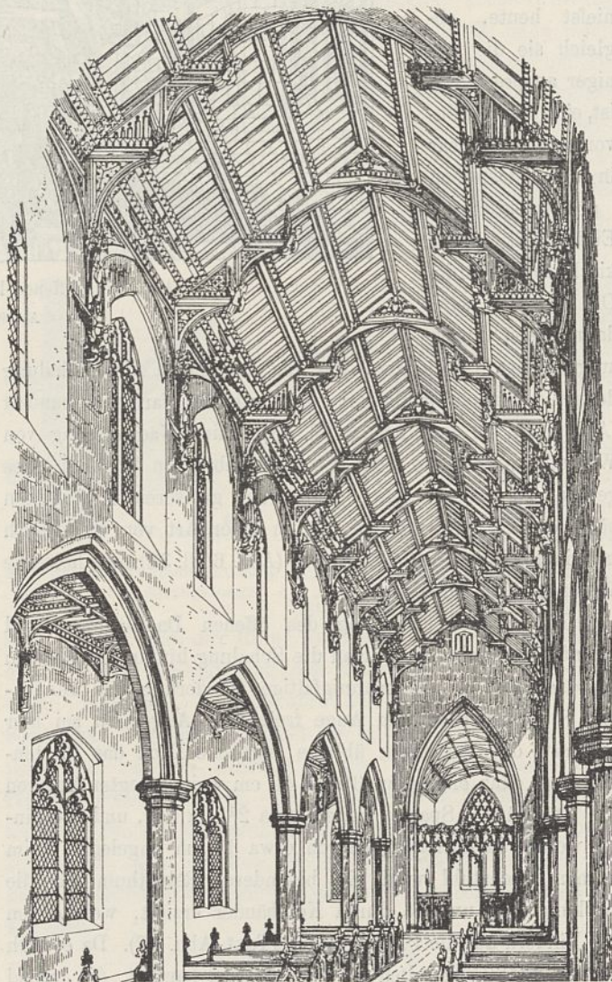
Abb. 45. Offener Dachstuhl ( hammerbeam roof ) aus der Kirche in Woolpit.
