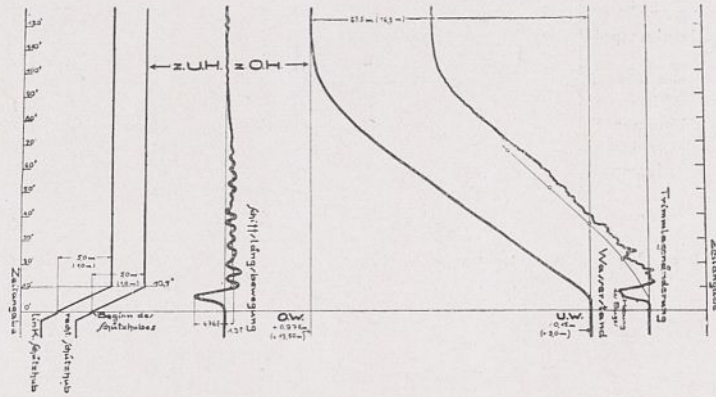
Abb. 19. Versuch Nr. V5 1 . Vorkammer nach Burkhardt, Schütz, Hubtor.
