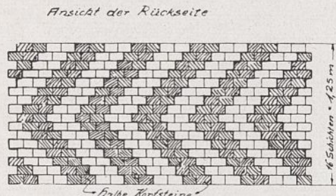
Abb. 8. Verbessertes Verblendmauerwerk mit Winkelverband.
