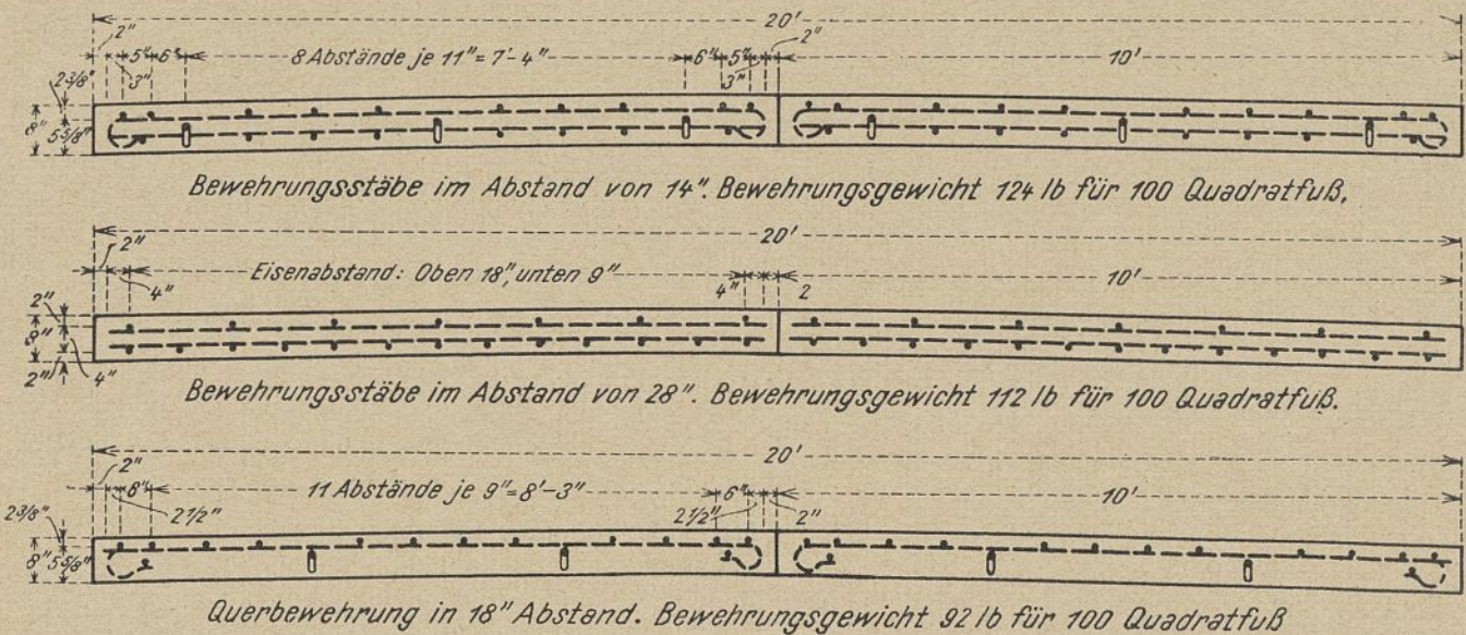
Abb. 3. Bewährte Typen von Betondecken mit Knoteneiseninlagen.
