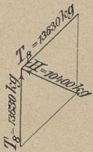
Abb. 2. Graphische Ermittlung des Horizontalschubs.
