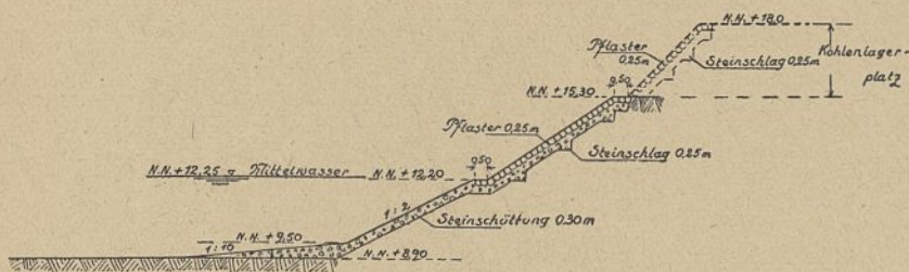
Abb. 22. Uferbefestigung im Turbinenunterkanal. M. 1:300.
