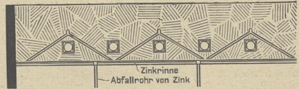
Abb. 4. Ostflügel. Spuren der alten Bedachung an der inneren Seite der Westattika.
