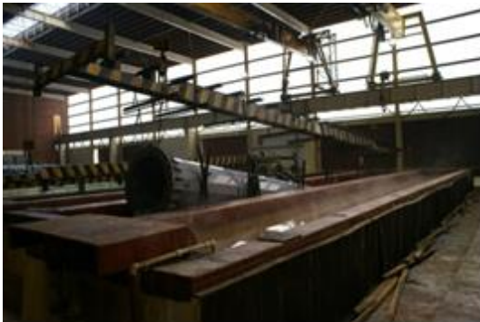
Rys. Z-A/7. Wytrawianie członu
