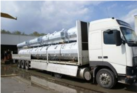
Rys. Z-A/9. Transport słupa na budowę
