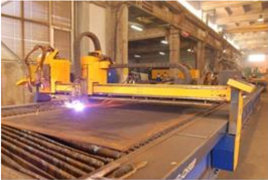
Rys. Z-A/1. Wycinanie trapezowych formatek
