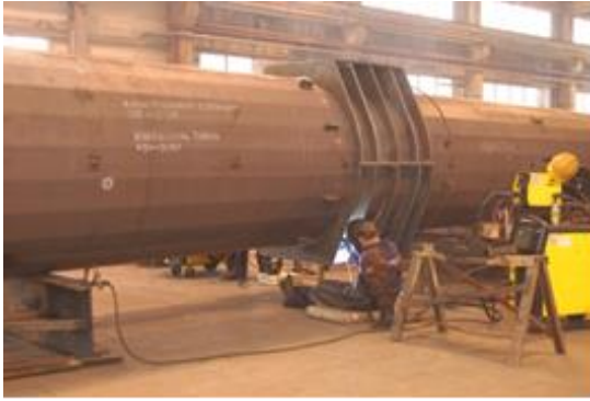
Rys. Z-A/5. Spawanie gniazd mocowania poprzeczników
