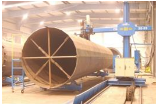
Rys. Z-A/4. Spawanie wzdłużne członu
