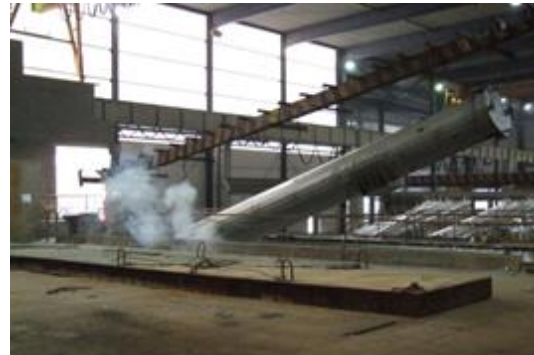
Rys. Z-A/8. Cynkowanie członu
