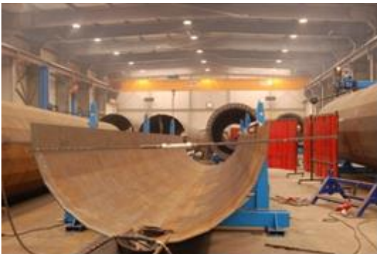
Rys. Z-A/3. Scalanie łupki za pomocą spawania
