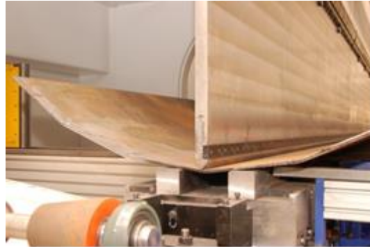
Rys. Z-A/2. Formowanie łupki na prasie krawędziowej
