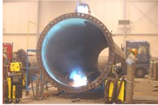
Rys. Z-A/6. Spawanie płyty podstawy
