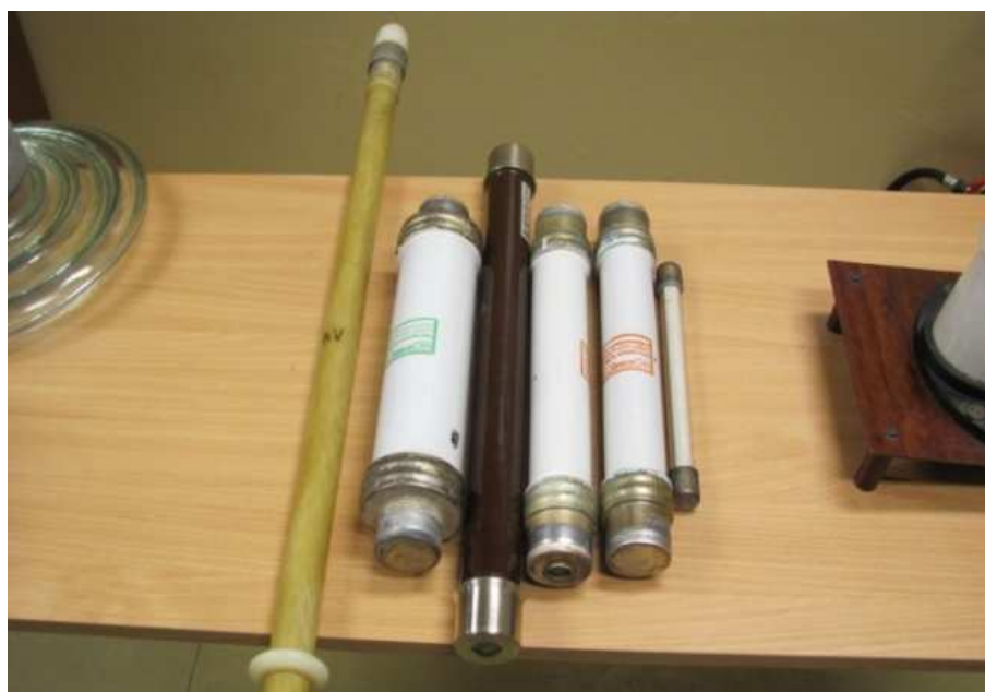
Rys. 4.5 Ogólny widok badanych izolatorów walcowych. [Zdjęcia własne].
