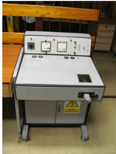
Rys. 4.3 Ogólny widok wykorzystanego układu probierczego wysokiego napięcia [zdjęcie własne].
