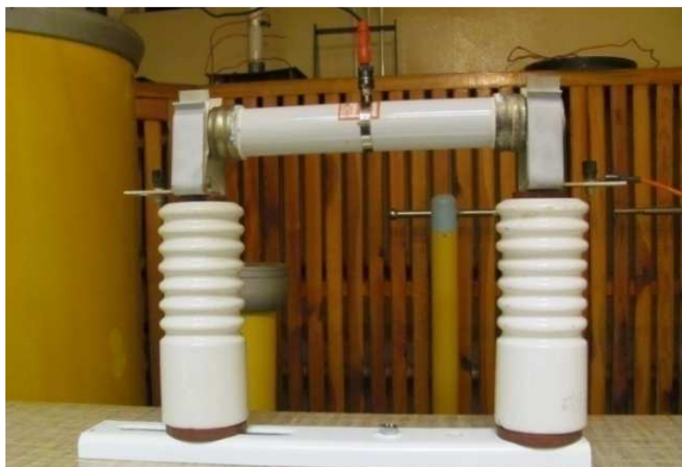
Rys. 4.6 Zdjęcie izolatora walcowego wykonanego z porcelany typu WPP/WPK, obrazujące sposób montażu obiektu przygotowanego do badań. [Zdjęcia własne].
