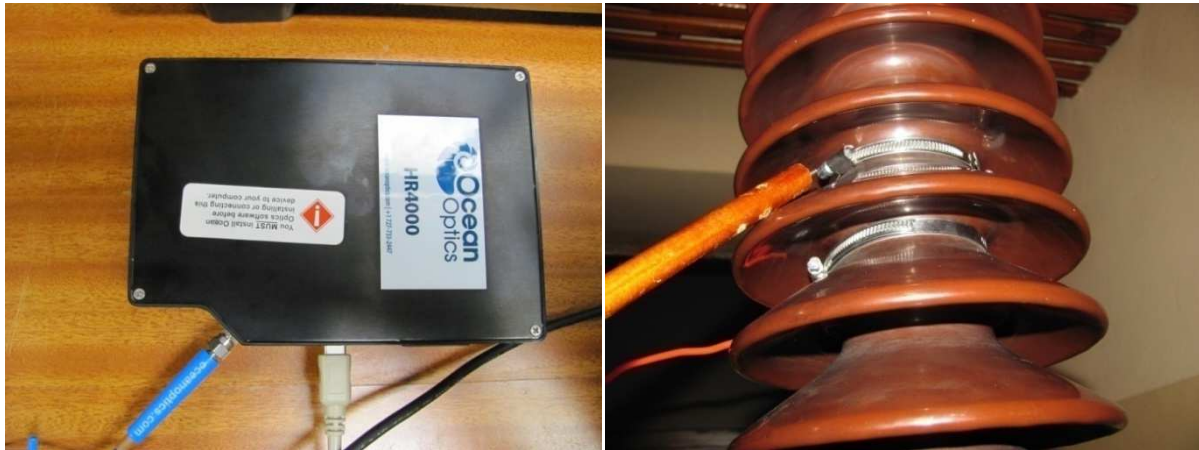
Rys. 4.8 Po lewej: ogólny widok spektrofotometru firmy Ocean Optics typ HR4000. Po prawej: sposób montażu spektrofotometru na pojedynczym kołpaku izolatora długopniowego wykonanego z porcelany. [Zdjęcie własne].
