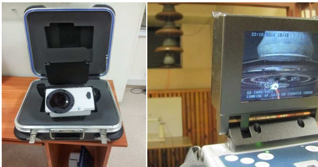
Rys. 4.7 Po lewej: zdjęcie kamery UV DayCor Superb. Po prawej: ogólny widok ekranu kamery podczas rejestracji widm emisyjnych generowanych przez WNZ. [Zdjęcie własne].
