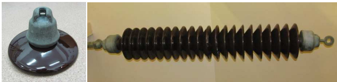
Rys. 4.4 Zdjęcia układów izolacyjnych poddanych badaniom. Po lewej: izolator kołpakowy porcelanowy typu LK. Po prawej: izolator długopniowy wykonany z porcelany (obiekt obrócony o 90°) typu LS. [Zdjęcia własne].
