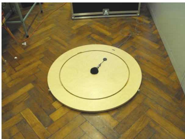
Rys. 5.3 Mikrofon umieszczony na odbijającej powierzchni pomiarowej z osłoną przeciwwietrzną.
