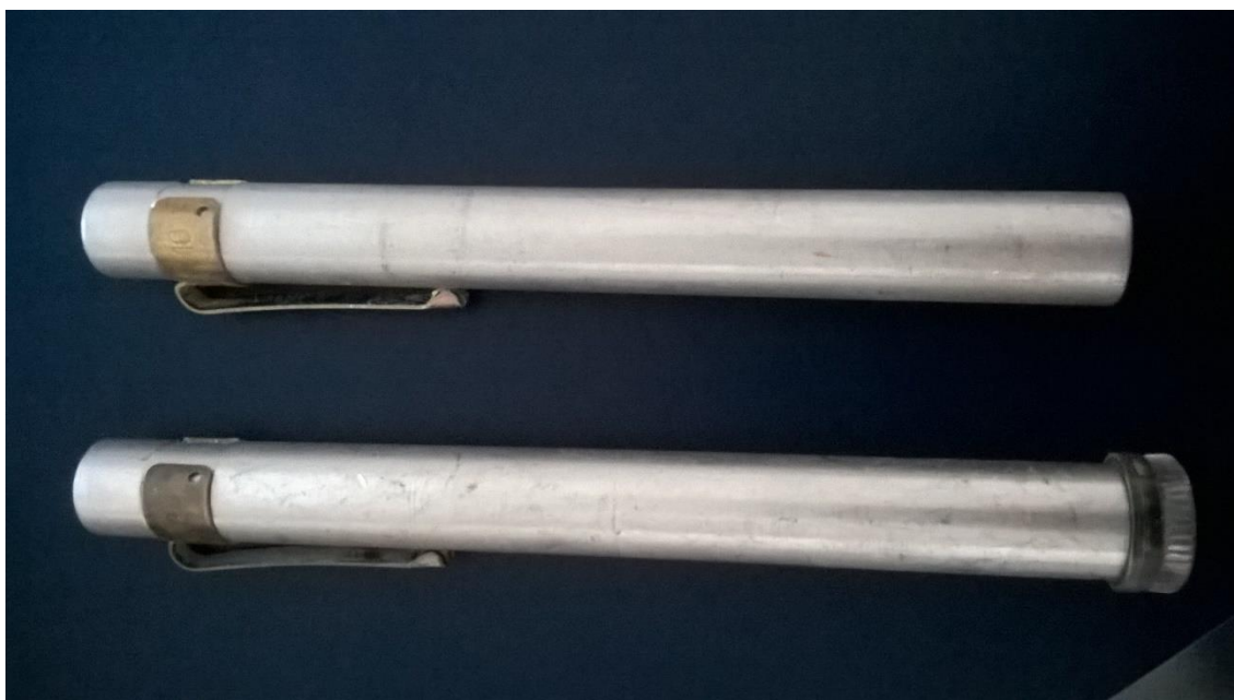
Rys.4.6 Dozometr DKP-50 oparty na konstrukcji komory jonizacyjnej
