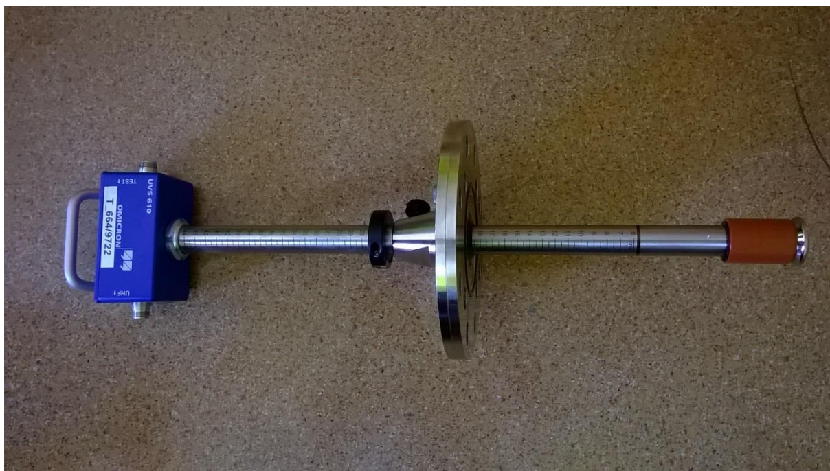
Rys. 3.3 Sonda UHF do badań nad wyładowaniami niezupełnymi
