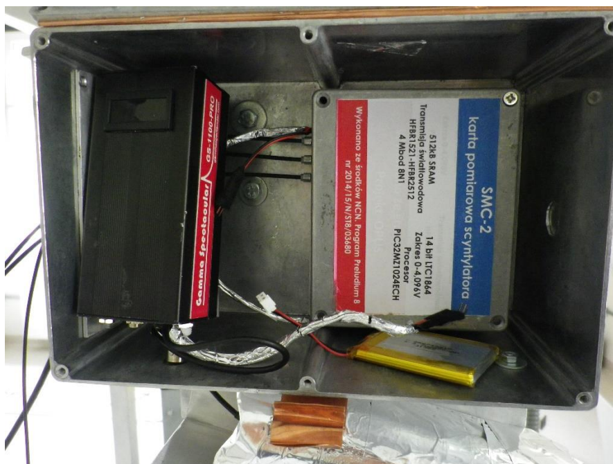
Rys. 5.9 Wnętrze detektora scyntylicyjnego. Karta pomiarowa oraz wysokonapięciowy zasilacz fotopowielacza
