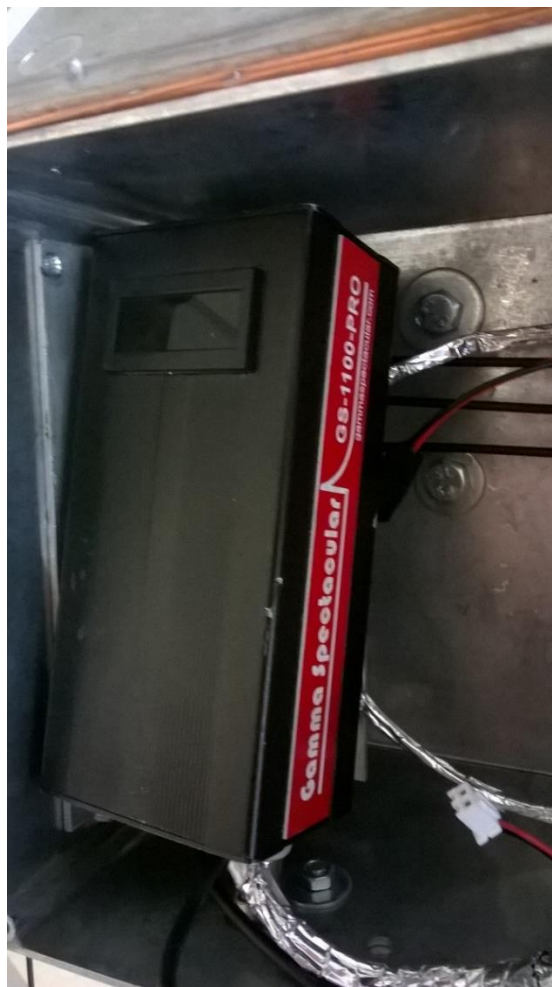
Rys.5.12 Zasilacz wysokonapięciowy scytlatora z wbudowanym wzmacniaczem scytlacyjnym
