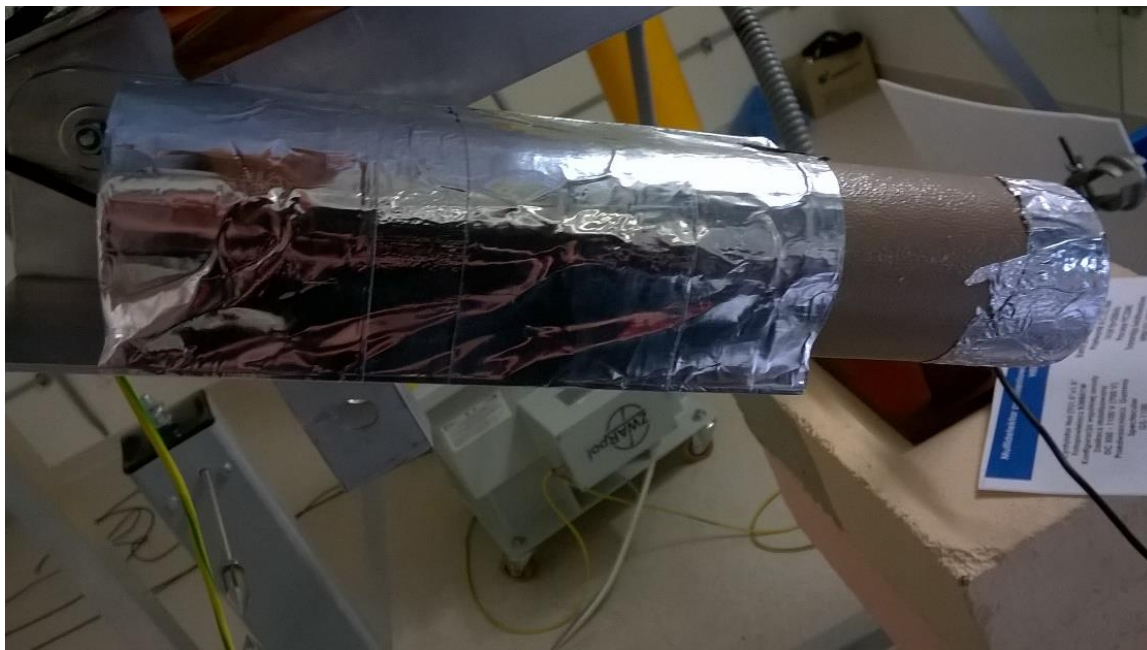
Rys. 5.11 Sonda scyntylacyjna z fotopowielaczem
