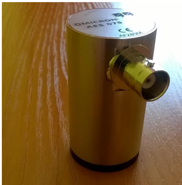
Rys. 3.4 Sonda akustyczna wykorzystywana w badaniach diagnostycznych metodą akustyczną
