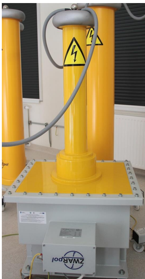
Rys. 5.3 Zdjęcie transformatora wysokonapięciowego
