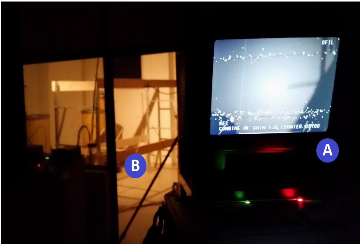
Rys. 6.4 Widok ogólny stanowiska pomiarowego podczas wykonywania pomiaru kamerą UV. Widoczna oświetlona celka w czasie pomiarów była zaciemniona w celu umożliwienia prawidłowej rejestracji widm przez spektrofotometr – została oświetlona specjalnie do wykonania tego zdjęcia (A – kamera UV z widocznym ekranem pozwalającym na obserwację pomiaru, B – stanowisko do modelowania linii trójfazowej – widok przez otwarte drzwi do celki). [Zdjęcie własne].
