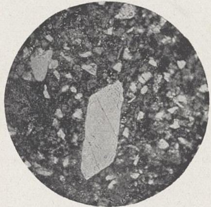
Fig. 8. Spoiwo fosforytowe z Niezwisk, światło zwykłe, pow. około 30-krotne, w środku pola widzenia kwarczec autogeniczny.
