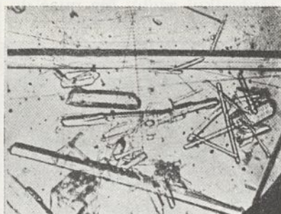
Rycina 10. Siarczan potasowy. Przesycenie \Delta C = 10,0 . Wzajemny stosunek y/x = 25,0 .
