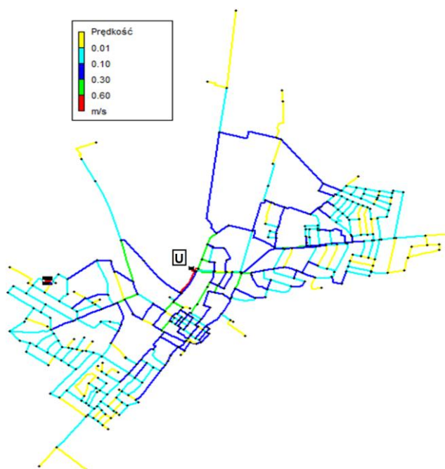
Rys. 12. Rozkład prędkości w układzie dla II wariantu hipotetycznego – 19.05.2015 r.; U-ujęcie
