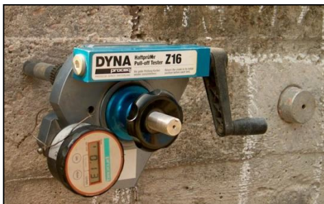
Rys. 7. Widok urządzenia wykorzystanego do pomiaru wytrzymałości betonu na rozciąganie (odrywanie)
