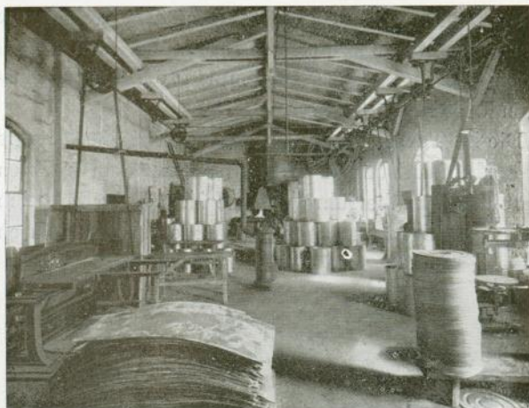
Fabrikation der Blechtrommeln zum Versand des Carbids.
