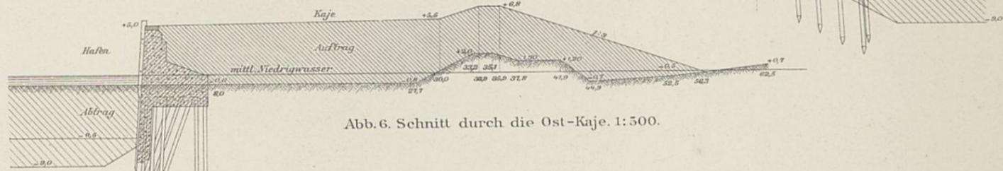
Abb. 6. Schnitt durch die Ost-Kaje. 1:500.
