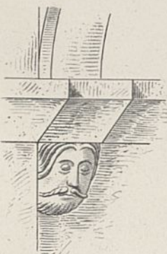
Abb. 9. Kragstein für den Diagonalbogen am 3. Nordpfeiler.
