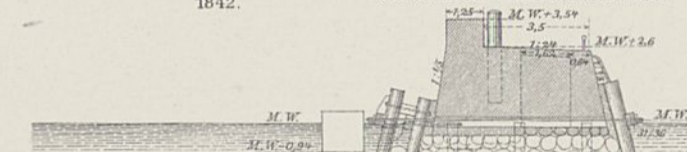
Abb. 22. Oestliches Bohlwerk an Stelle der Binnenkisten 1850.
