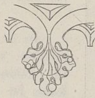
Abb. 5. Freie Blattendigungen des Blindmafswerkes im Erdgeschofs. 1:10.
