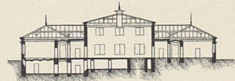
Abb. 3. Längenschnitt des Küchengebäudes.
