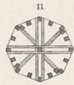
Abb. 4 Verbindung der Sparren mit den Pfetten und Befestigung der Kupfertafeln auf der Schalung.
