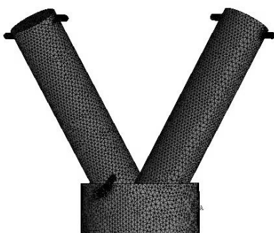
Rys. 6: Siatka głowicy składała się z 319 413 elementów i 76 475 węzłów
