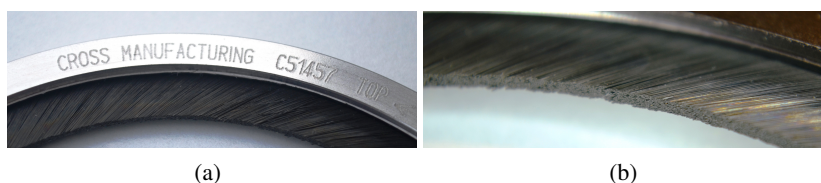
Rys. 1: Fragment uszczelnienia szczotkowego poddane analizie MES: a) fragment uszczelnienia szczotkowego, b) palisada drucików w powiększeniu
