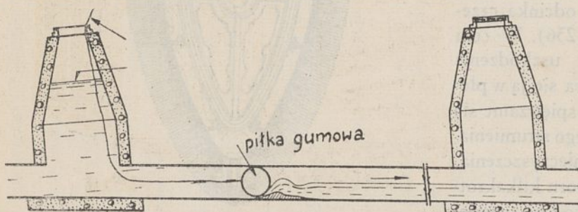
Rys. 236. Oczyszczanie kanału piłką gumową.
