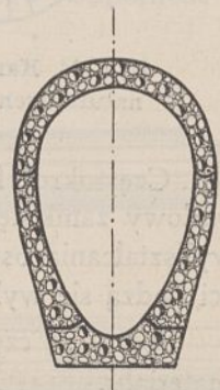
Rys. 63. Przewód wybudowany z gotowych segmentów.
