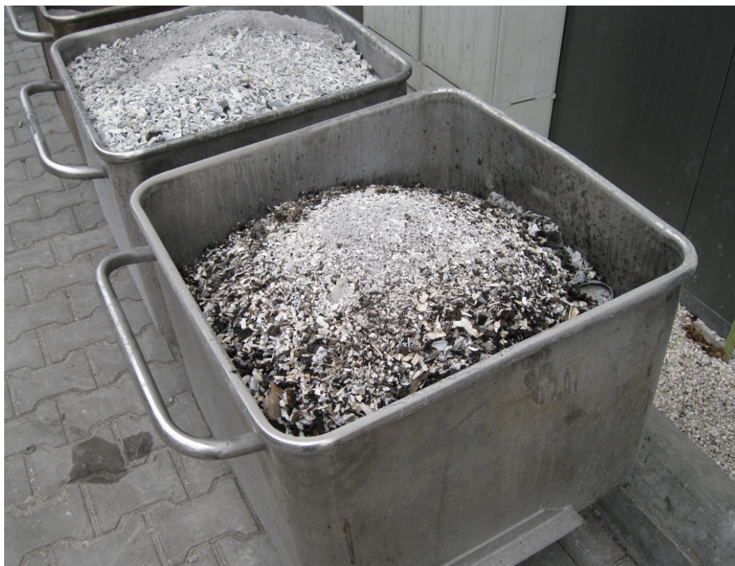
Fot. 5. Pozostałość stała uzyskiwana w wyniku spalania ubocznych produktów pochodzenia zwierzęcego.
