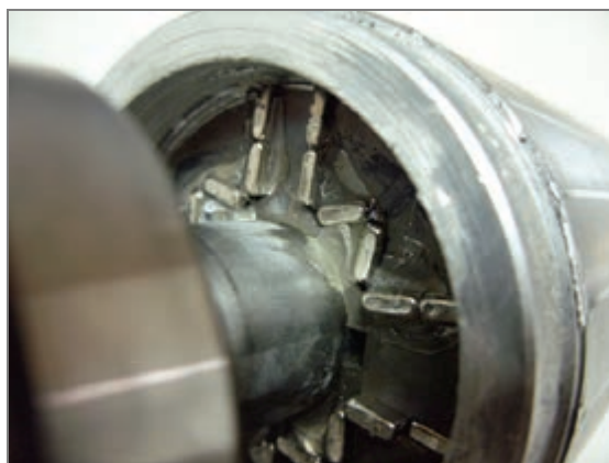
Rys. 1. Wirnik nr 1 – rozmieszczenie magnesów w układzie W
