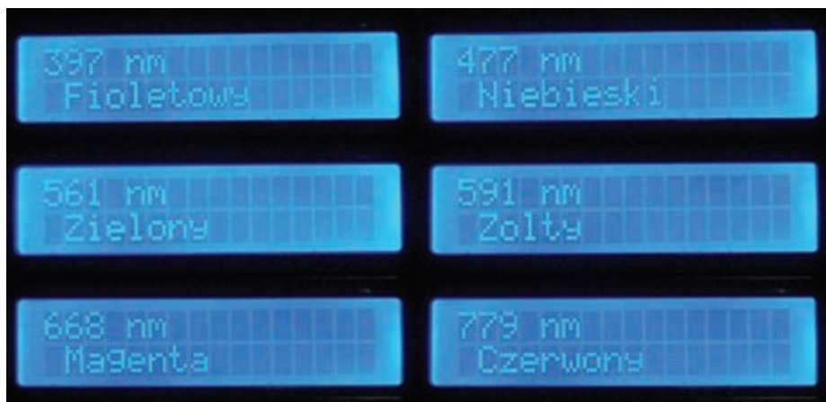
Rys. 9. Wyniki przykładowych pomiarów długości fal światła odbitych z rzeczywistych elementów wraz z nazwami przedziałów (do których zostały zaklasyfikowane)
