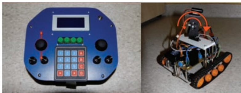
Rys. 9. Obrót platformy wokół osi poziomej
