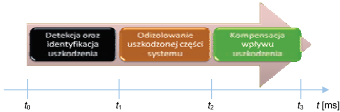
Rys. 1. Sekwencja zdarzeń w układach napędowych ze sterowaniem tolerującym uszkodzenia elementów napędu
