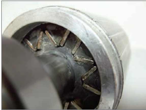
Rys. 2. Wirnik nr 2 – rozmieszczenie magnesów w układzie VV
