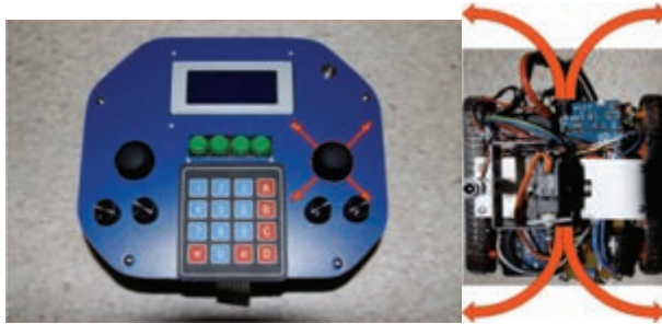
Rys. 7. Panel operatorski oraz łożak w trakcie zmiany kierunku ruchu (skręcanie)
