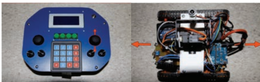
Rys. 5. Panel operatorski oraz łazik w trakcie ruchu według liniowej trajektorii
