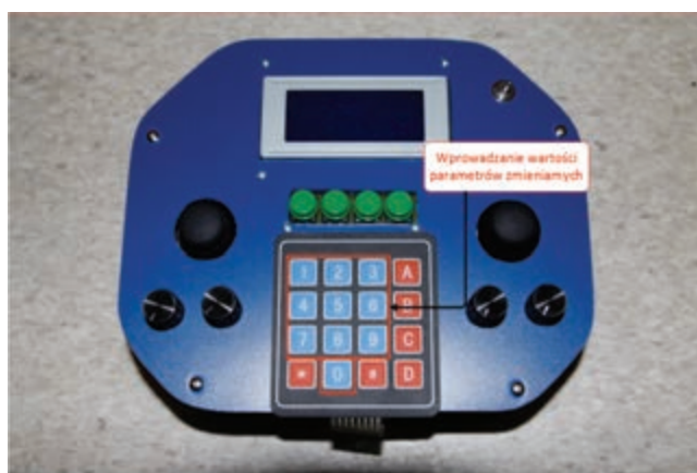
Rys. 10. Sterowanie precyzyjne za pomocą klawiatury membranowej
