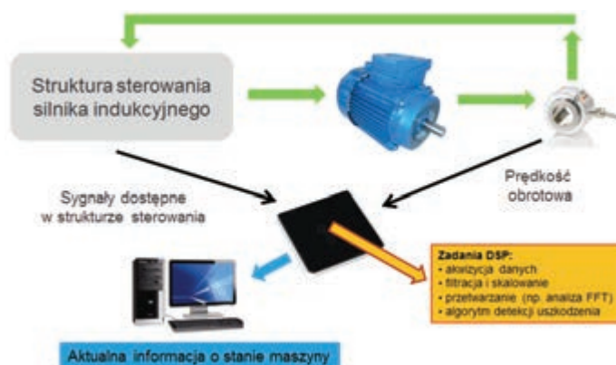
Rys. 7. Koncepcja działania systemu diagnostycznego z detektorem neuronowym
