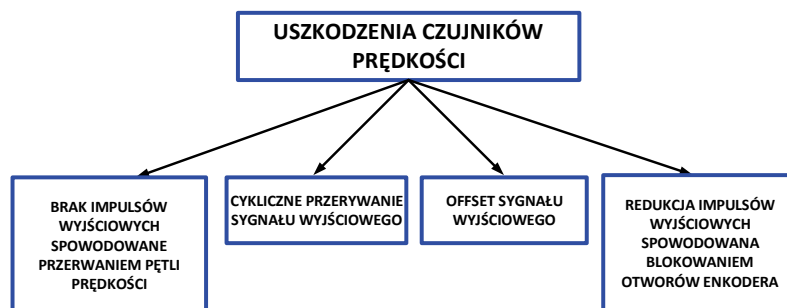
Rys. 5. Rodzaje uszkodzeń czujników prędkości
