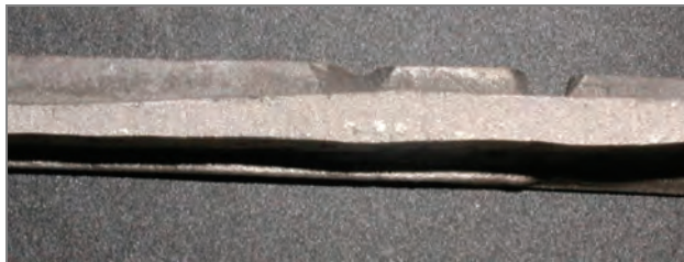
Rys. 12.13. Przelom wzdłużny łopatki wykonanej ze sferoidalnego żeliwa nr 5B. Zużycie po 15 h pracy
