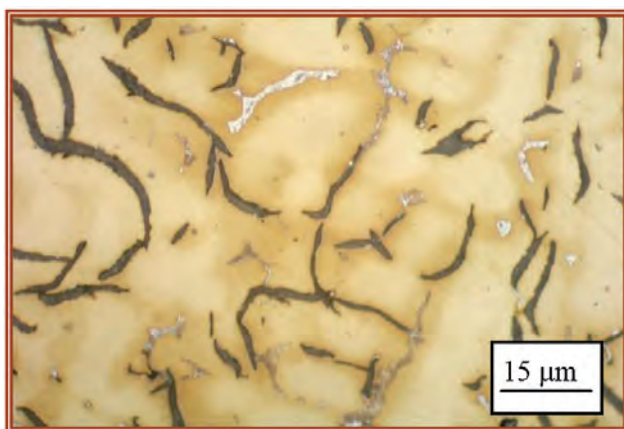
Rys. 11.16. Żeliwo I. Austenityczna struktura surowego odlewu; traw. Mi1Fe
