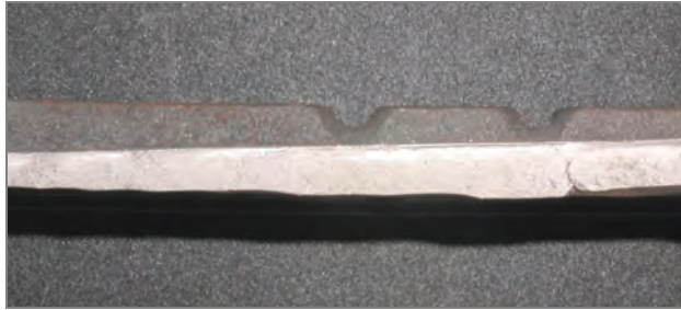
Rys. 12.12. Przelom wzdłużny łopatki wykonanej ze staliwa (stop nr 7B). Zużycie po 15 h pracy
