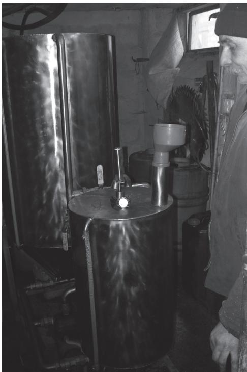
Rys. 3. Instalacja do produkcji estrów PEM-300
