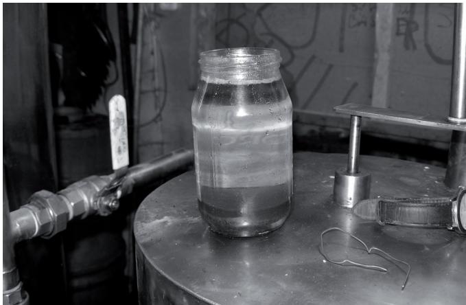
Rys. 4. Trwale rozwarstwienie związków na metyloester i glicerynę
