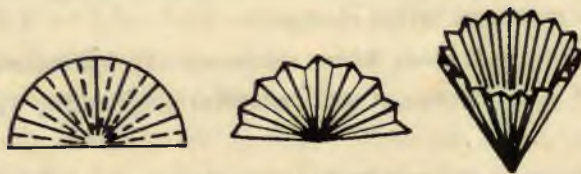
Rys. 1.4/3. Wykonanie sączka karbowanego
