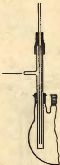
Rys. 1.6/10. Sposób odblokowywania rurki doprowadzającej gaz z zatykających ją w czasie reakcji kryształów
