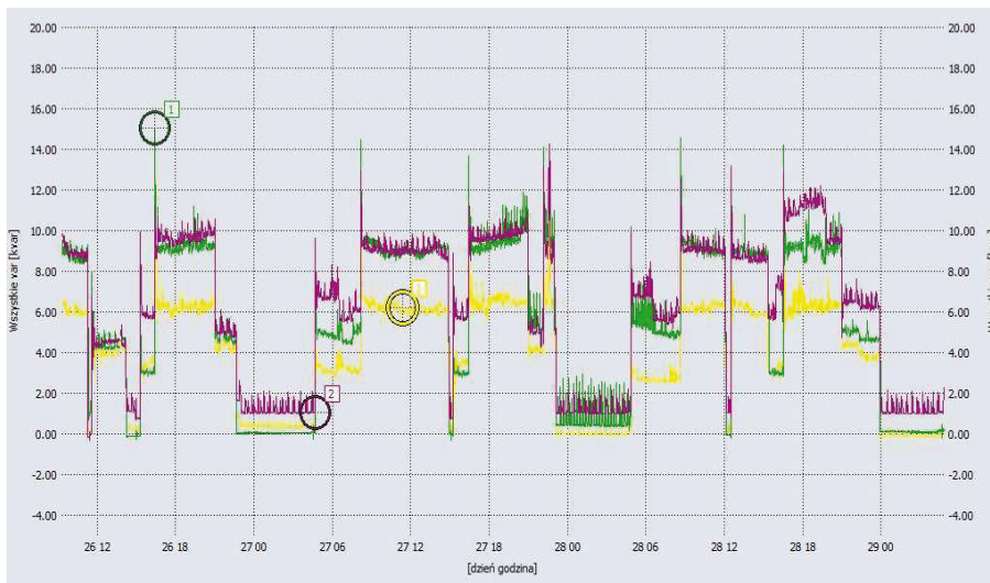
Rys. 5. Wykres czasowy poboru mocy biernej Fig. 5. Timing diagram of reactive power consumption
